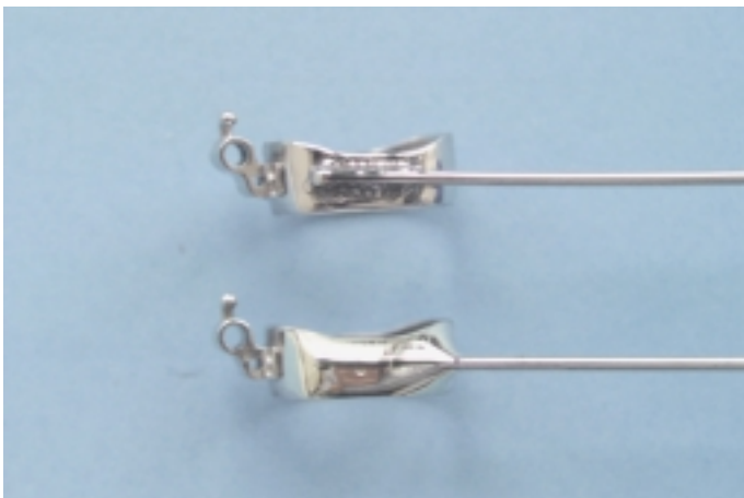
Fig. 1 - Provini realizzati in laboratorio con le due metodiche di saldatura: A - saldatura laser; B - saldobrasatura
