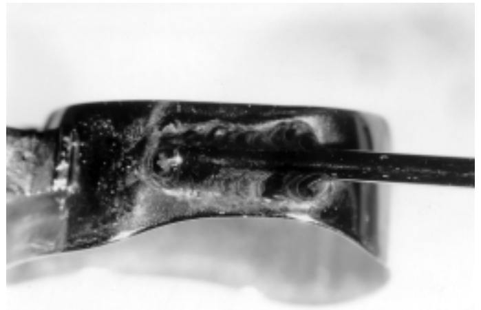
Fig. 5 - Saldatura laser al microscopio
