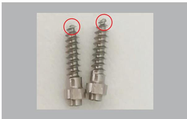
FIG. 28 - Frattura della punta della minivite da osso densamente mineralizzato dove non si è effettuato il foro pilota
