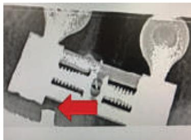
FIG. 3 - Esempio di frattura intra-orale della struttura di un espansore su miniviti durante la fase attiva di espansione (cortese concessione del Dott. Ugo D'Aloja)
