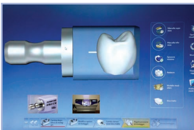
Fig. 11 - Dopo il progetto, la corona virtuale è ora pronta per essere fresata. Si noti il suo posizionamento all'interno del blocco di litio presinterizzato
