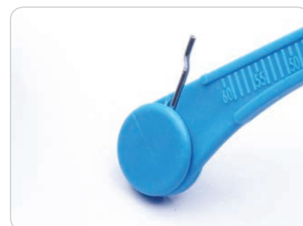
Fig. 6 - Verificare che la chiave abbia raggiunto lo stop sull'estremità circolare del manico
