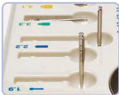
Fori calibrati sono stati previsti per la verifica del diametro delle frese
