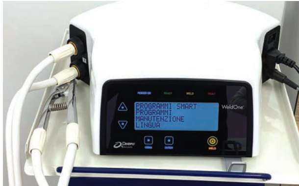
Fig. 9 - Sincristallizzatrice endorale usata per la saldatura
