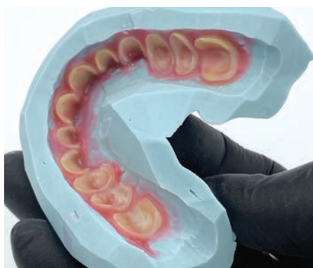
Fig. 19 - Preparazione della mascherina per la realizzazione della struttura protesica in resina calcinabile
