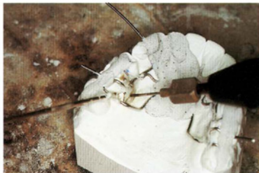
Brasatura con saldame ad alto tenore di argento esente da cadmio. I vari componenti sono bloccati con rivestimento. Le zone dove è stata apposta la cera collante dovranno essere totalmente
