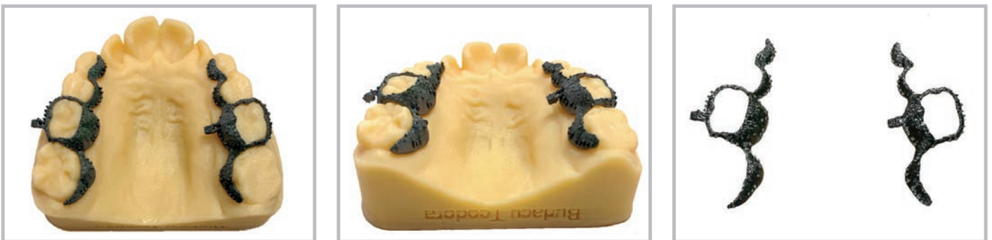
Fig. 3 - Elementi del dispositivo sinterizzati e verifica su modello master prototipato
