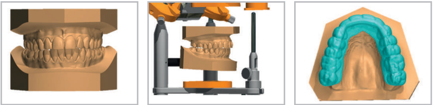
Fig. 19 - Modello virtuale, modello in articolatore e design placca oclusale gnatologica
