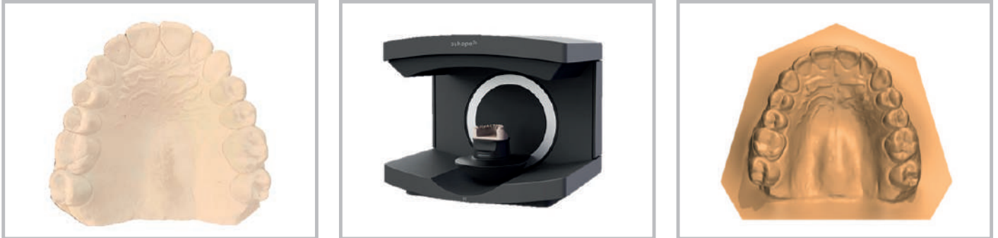
Fig.1a - Ricezione impronte in laboratorio e sua conversione dall'analogo al virtuale
